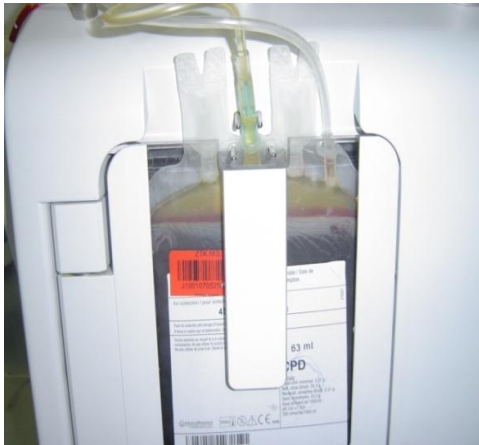
Слика 17. Аутоматска сепарација „buffy coat“-а
