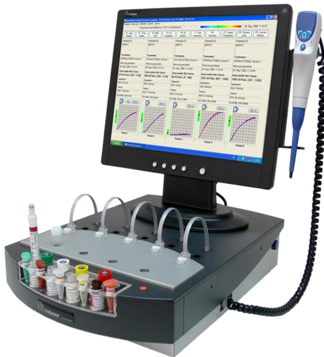
Слика 20. Импедантни агрегометар ( Multiplate analyzer, Roche )
