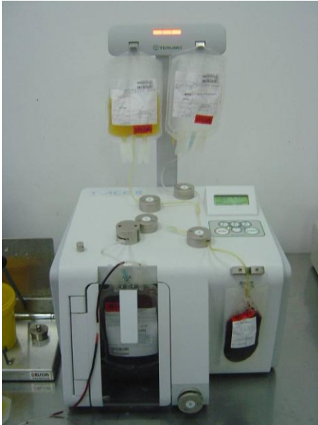
Слика 16. Аутоматска сепарација јединица целе крви на апаратима T-ACE II
